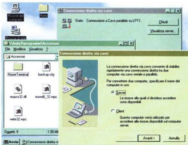
Figura 16 - Windows 95 - Collegamento diretto tra due computer. In Windows 95 troviamo anche una specie di... riassunto delle puntate precedenti. Contiene, in un certo senso, tutti gli strumenti operativi, tutti i servizi, tutte le funzionalità accessorie, che sono stati «scoperti» nei quindici anni di vita dell'Informatica Individuale. Qui vediamo l'accessorio Collegamento diretto tra due computer, che ai tempi del... DOS, veniva svolto da prodotti di utilità tipo il LapLink.
